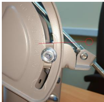
Рисунок 6. Гайки, удерживающие опорно-юстировочный кронштейн
